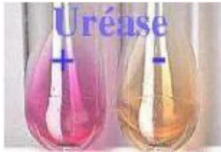
Figure 4 : Principe du test rapide à l'uréase dans un milieu urée-indole (Dahmani, 2015).
